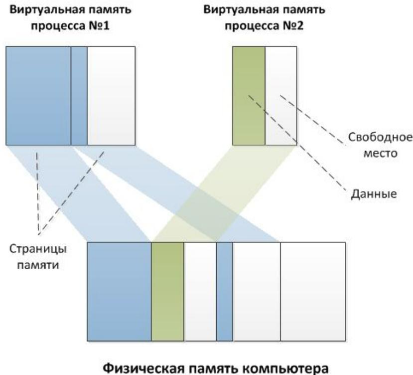
При запуске программы ОС создает процесс, загружая в его адресное пространство код и данные программы, а затем запускает главный поток созданного процесса.
