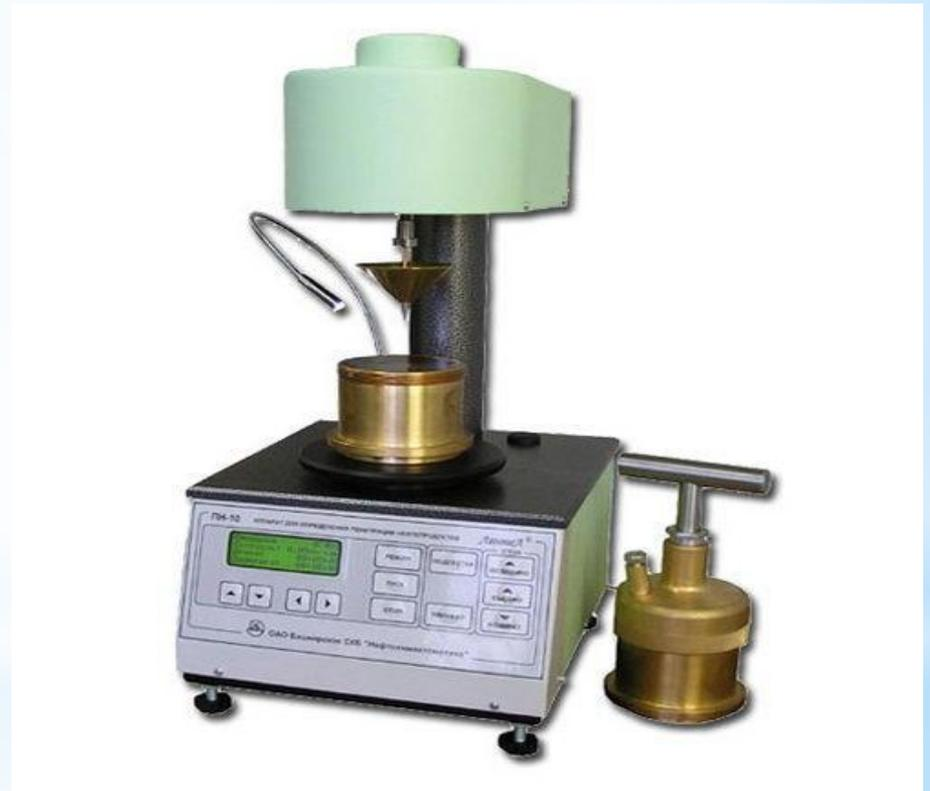
Рис. 13 - Пенетрометр
