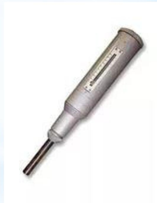
Рис. 8 - Склерометр
