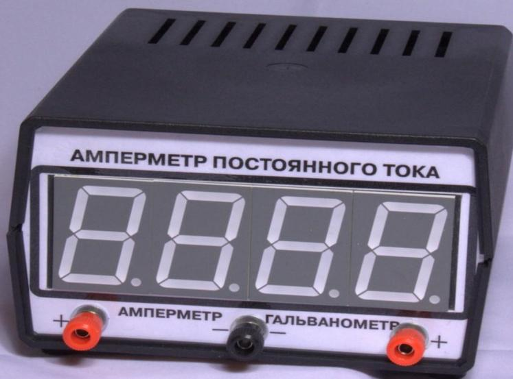
Рис. 22 - Амперметр
