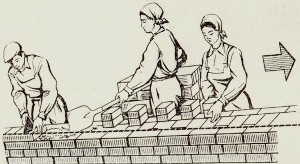
**Рис.4. Схема выполнения каменной кладки звеном «тройка».**
