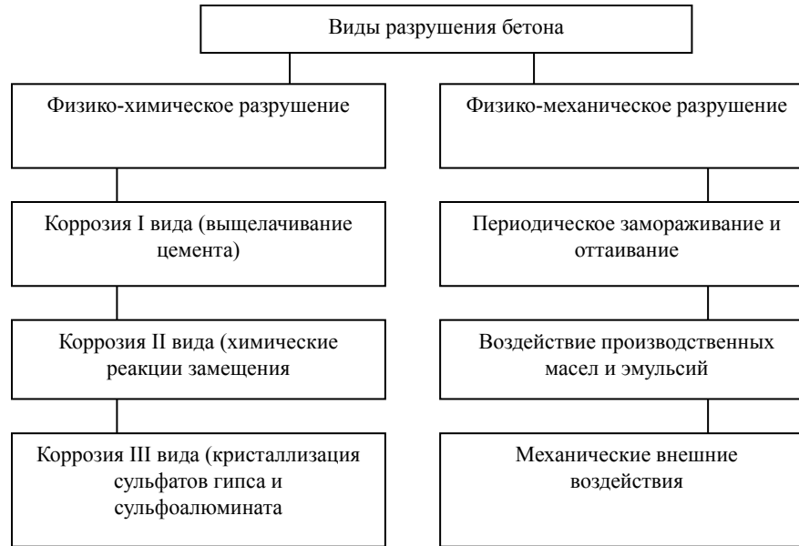
Рис. 13. Классификация видов разрушения бетона
