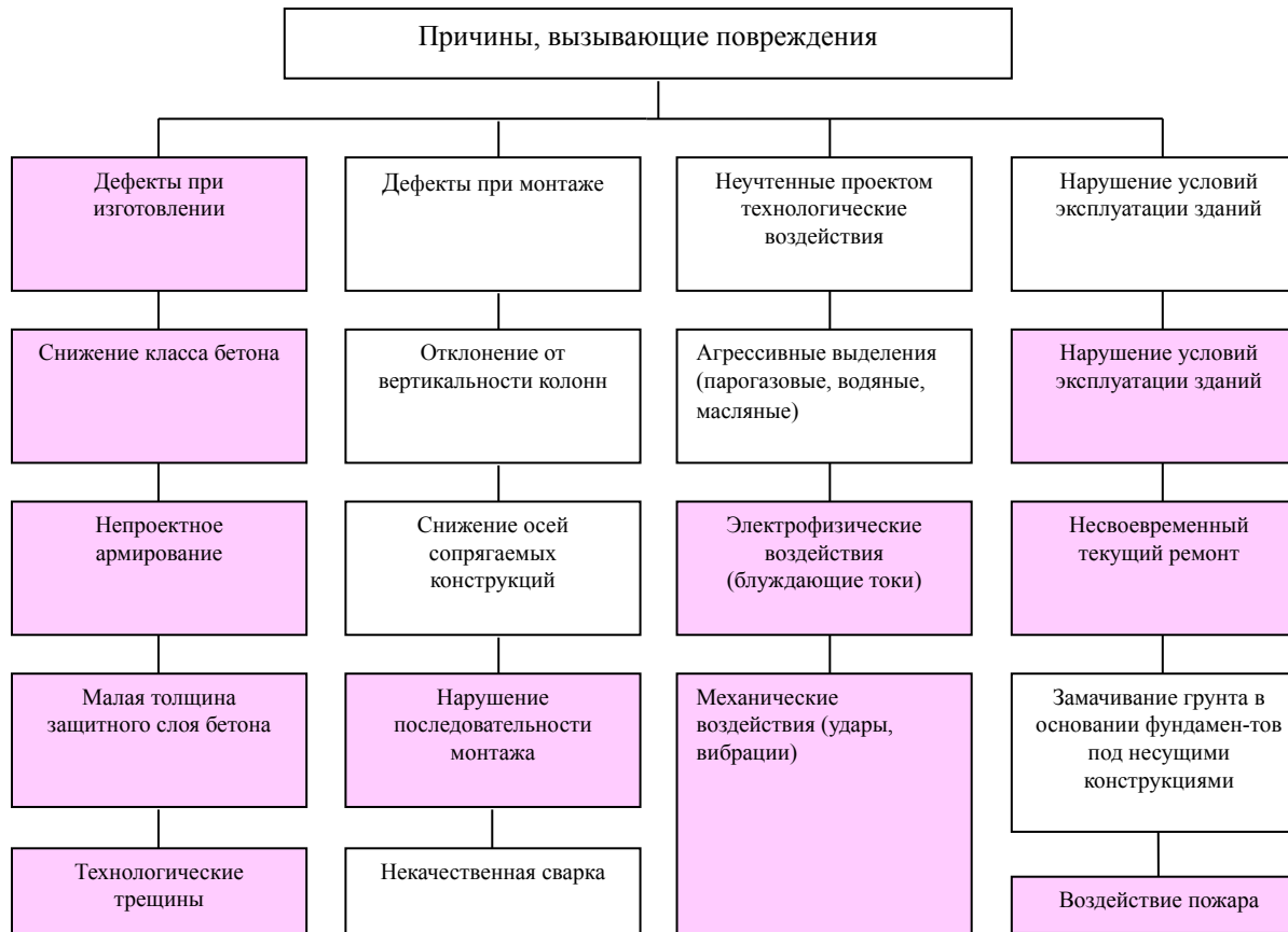
Рис.1. Классификация причин, вызывающих повреждения
