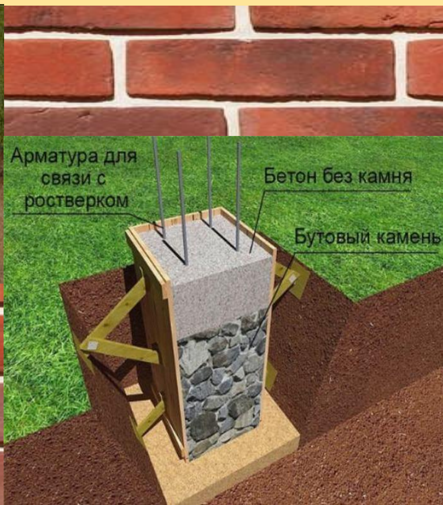
Конструкция бутового фундамента в непучинистых грунтах
