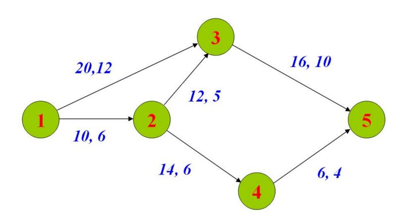
**Рис. 1.** Приведены продолжительности  $t_{ij}$  и минимально возможные времена  $d_{ij}$  выполнения работ соответственно (в днях).
