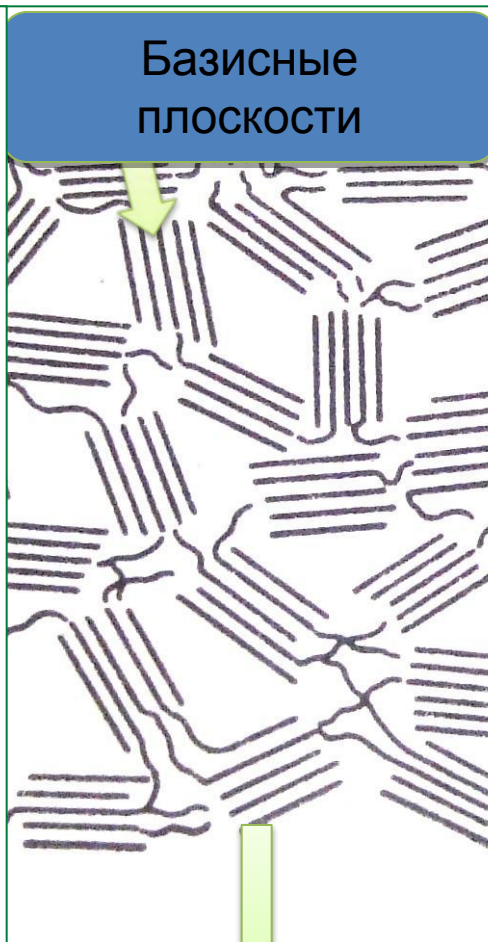
Прослойки аморфного углерода
