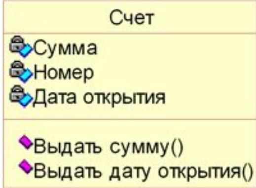
Рис.5.1. Изображение класса в нотации UML
