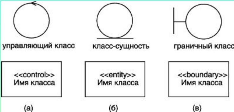
**Управляющий класс** (control class) — активный класс, отвечающий за координацию действий других классов. На каждой диаграмме классов должен быть хотя бы один управляющий класс. Управляющий класс может быть изображен в форме прямоугольника класса со стереотипом **<<control>>**
