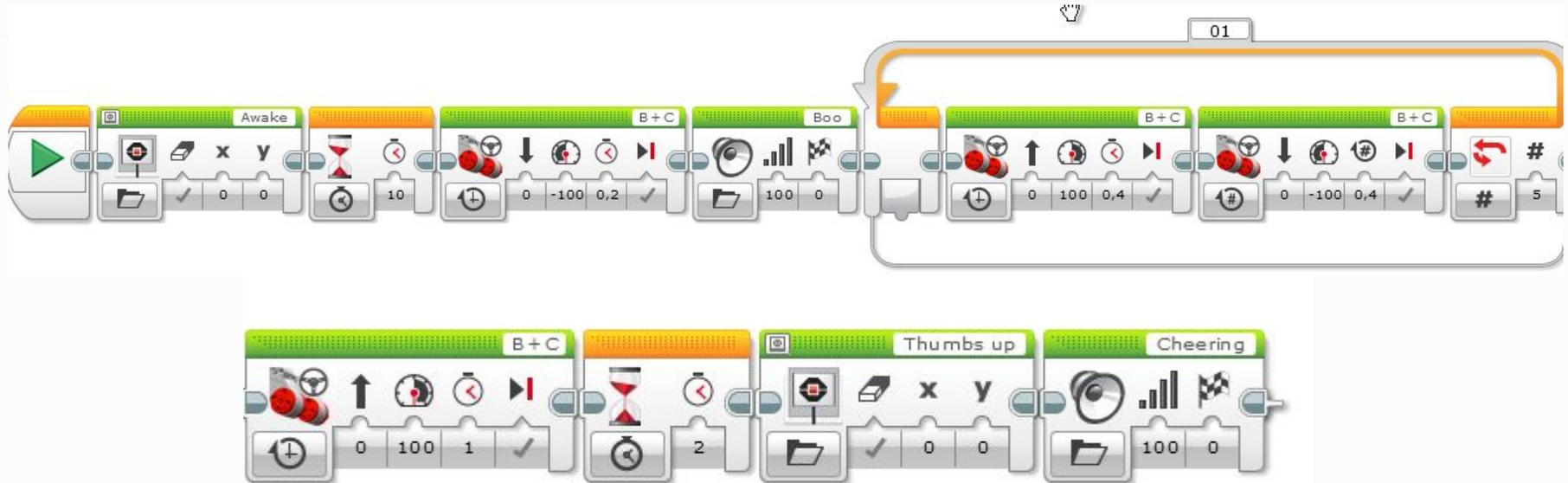
Моторы двигаются в течение доли секунды сначала в одну, потом в другую стороны, каждый раз увеличивая амплитуду движения
