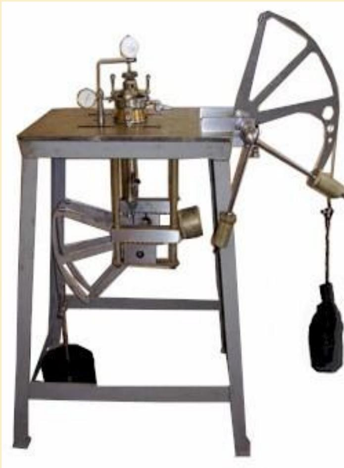
Для одного и того же грунта проводят серию испытаний при различных вертикальных давлениях
