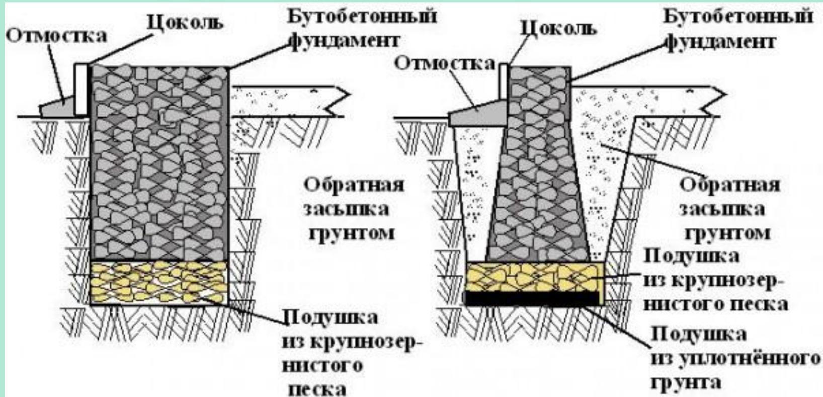
Конструкция бутобетонного фундамента в непучинистых грунтах
