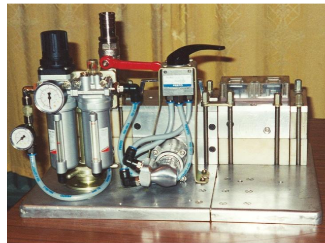
Инжектор ПСИ-1 для задувки кабеля.
