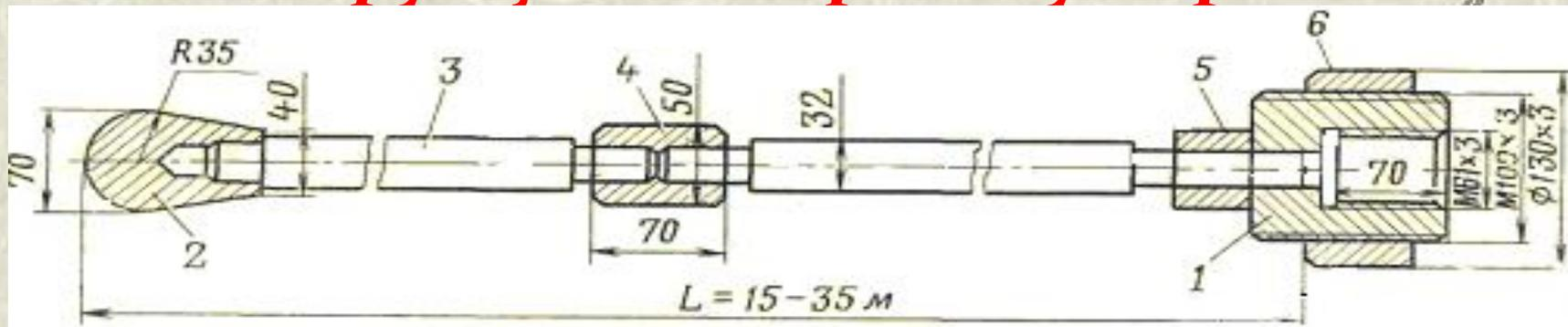
*Анкер стержневой конструкции из арматурной стали диаметром 32 мм с соединительной муфтой: 1 – подвижная анкерная головка; 2 – неподвижная анкерная головка; 3 – стержень анкера; 4 – муфта; 5 – контргайка; 6 – стопорная гайка*
