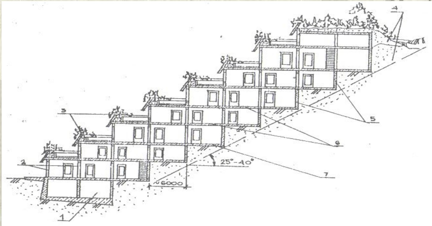
1 - эксплуатируемая удерживающая конструкция; 2 - вертикальные несущие элементы; 3 - озеленение террас; 4 - основание склона; 5 - стена, контактирующая с грунтом; 6 - диски перекрытия; 7 - фундамент
