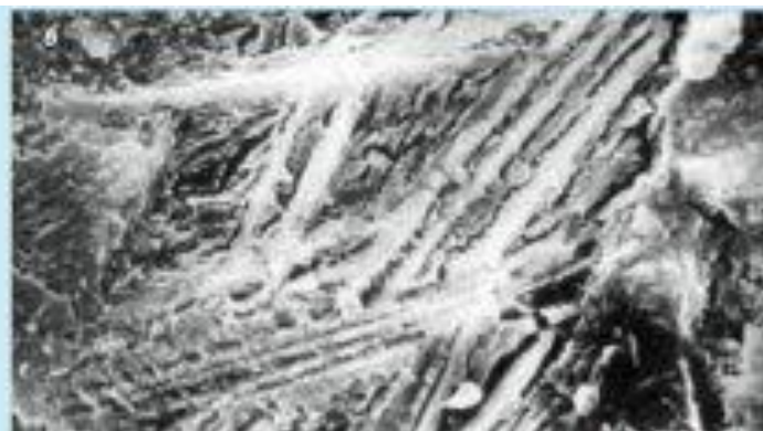
Микрофотографии поверхности скола цементного камня: а – цемента (x500); б – цемента с частицами нанокремнезема 0,02% (x500); в – цемента с частицами нанокремнезема 0,1% (x500)
