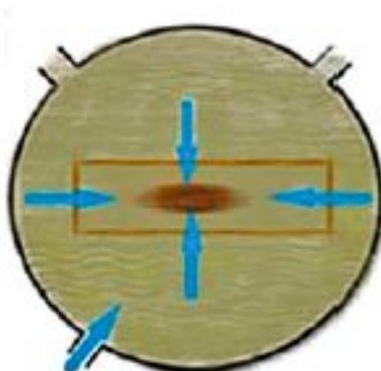
3. Создают избыточное гидравлическое давление, под действием которого антипирен проникает глубоко в структуру древесины.
