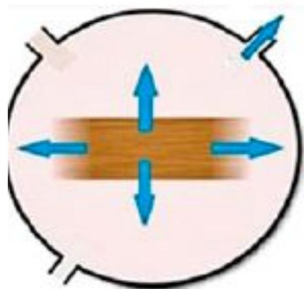
1. Древесину помещают в автоклав. В автоклаве создают разрежение, из пор древесины выкачивают воздух. Вакуум поддерживается.
