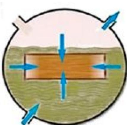
2. Наполняют резервуар раствором под вакуумом.
