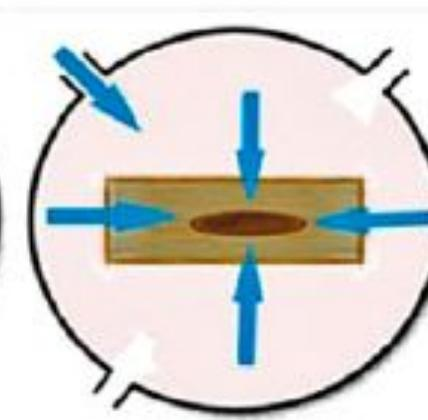
5. Благодаря пониженному давлению в древесине раствор с поверхности втягивается внутрь при восстановлении атмосферного давления в автоклаве. Обработанную древесину оставляют сохнуть.
