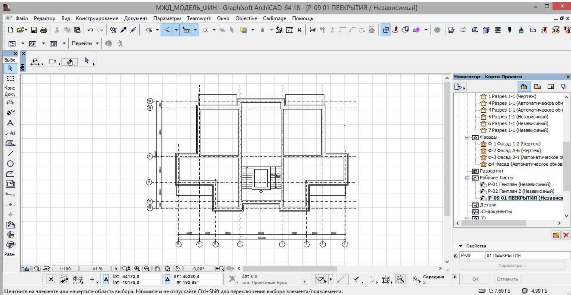
Линии плана – стены перо 21 – 0,25 мм, оси – самое тонкое перо № 1 – 0,12 мм
