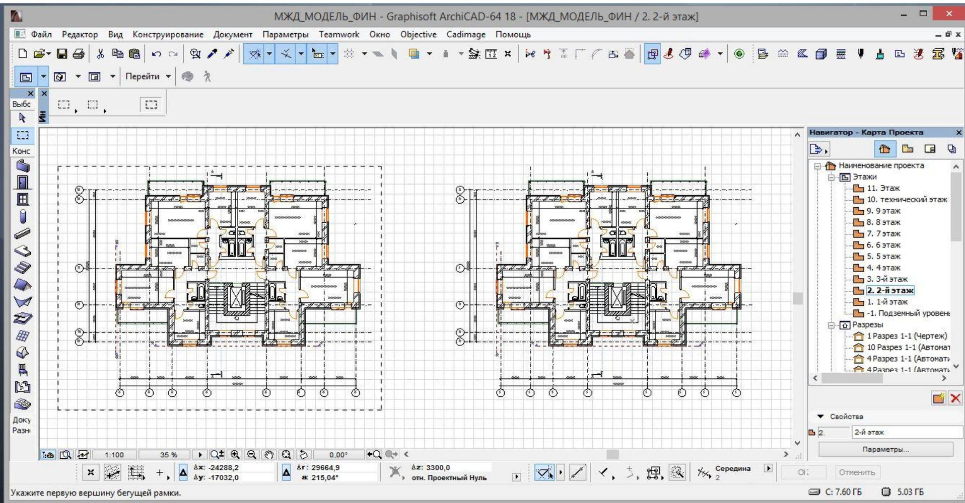
Выбираем инструмент Дверь. Командой CTRL-A выбираем все двери и удаляем их.
