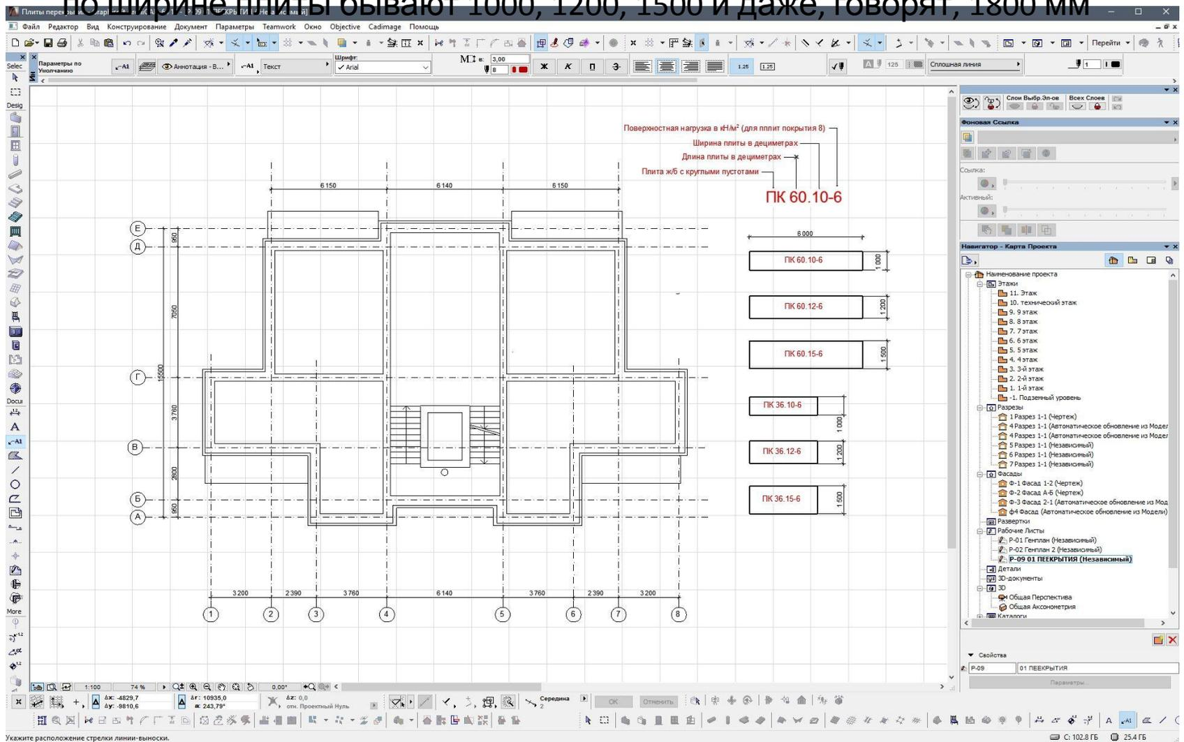
Раскладываем плиты с учетом опирания их на стены на 120 мм.
