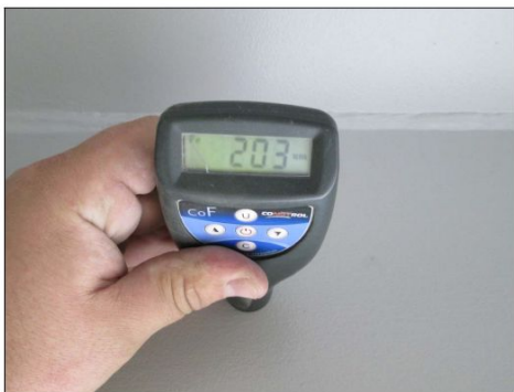
Определение толщины лакокрасочного покрытия прибором COF
