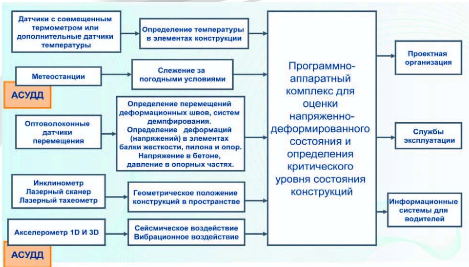
Рис. 3. Система контроля качественного состояния конструкции
