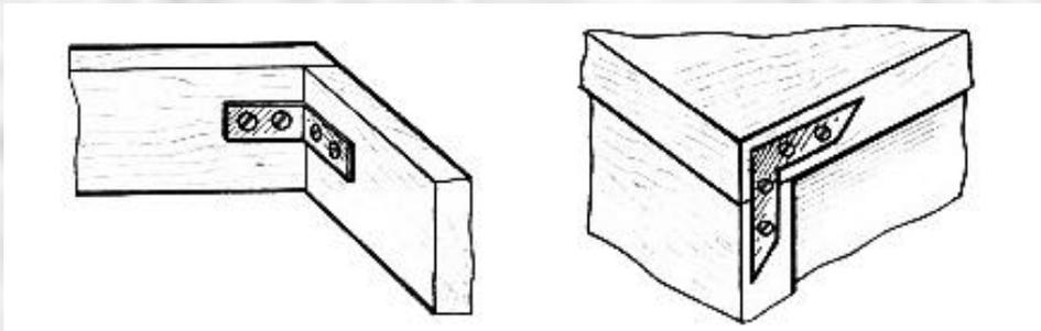
Соединение детали мебели с помощью уголка
