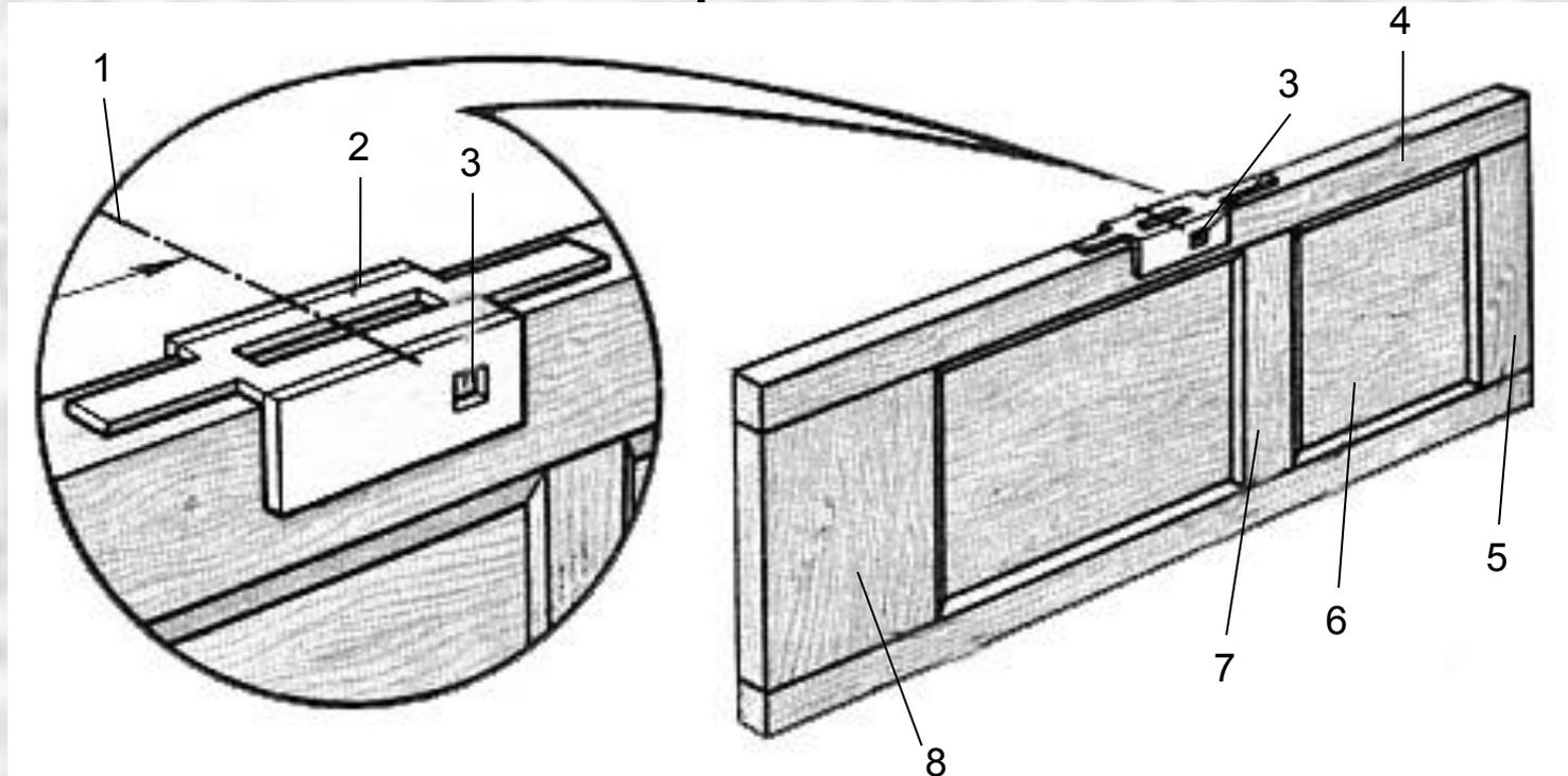
1 – ось шаблона, 2 – шаблон, 3 – замочная скважина, 4 – вертикальный брусок двери, 5 – верхний горизонтальный брусок, 6 – филенки, 7 – средний горизонтальный брусок, 8 – нижний горизонтальный брусок
