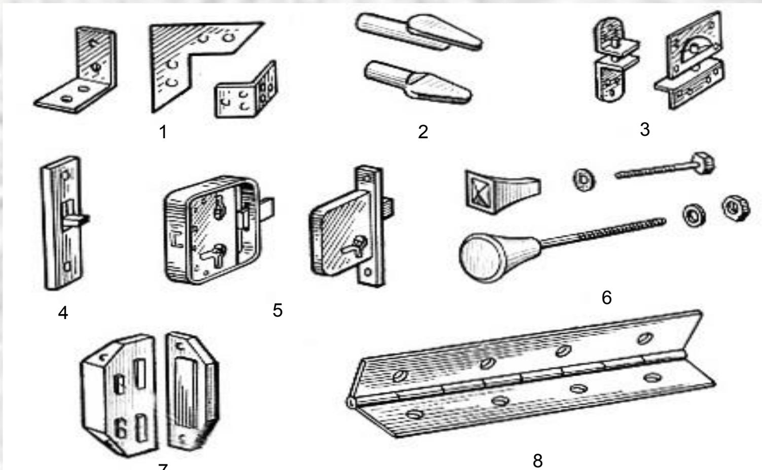
1 – уголки, 2 – полкодержатели, 3 – стяжки, 4 – засов, 5 – замки, 6 – ручки, 7 – магнитная защелка, 8 – петля рояльная
