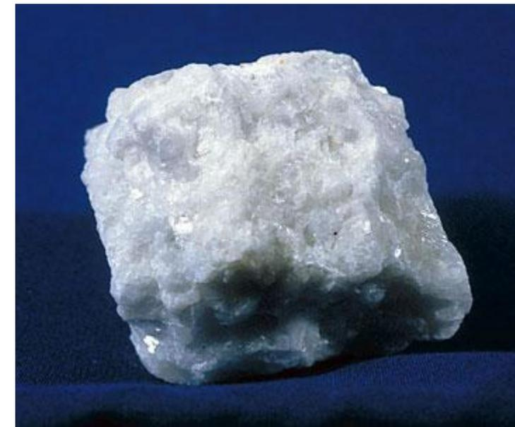
**Мел**  $\text{CaCO}_3$  также является осадочной горной породой белого цвета, которая не растворяется в воде и имеет органическое происхождение. В основном, он состоит из карбоната кальция и карбоната магния и оксидов металла.
