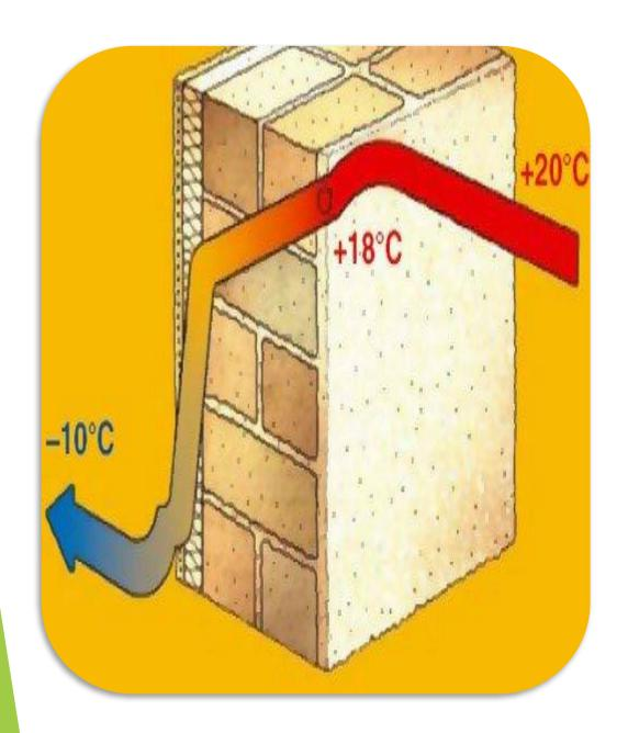
Теплопроводность — одно из важнейших свойств бетона, применяемого в ограждающих конструкциях. Чем легче бетон, тем, как правило, меньше его теплопроводность, поскольку уменьшение плотности бетона связано с повышением пористости, т. е. с вовлечения в объем бетона воздуха, являющегося в небольших порах прекрасным теплоизолятором.
