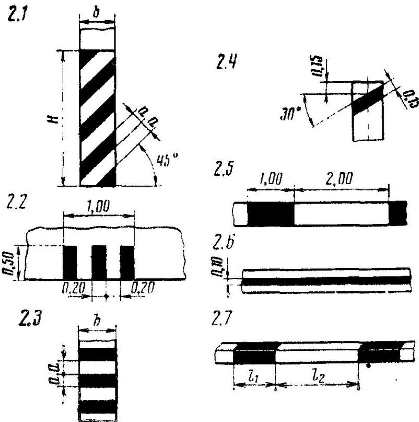
Рис. 18.11. Виды вертикальной разметки
