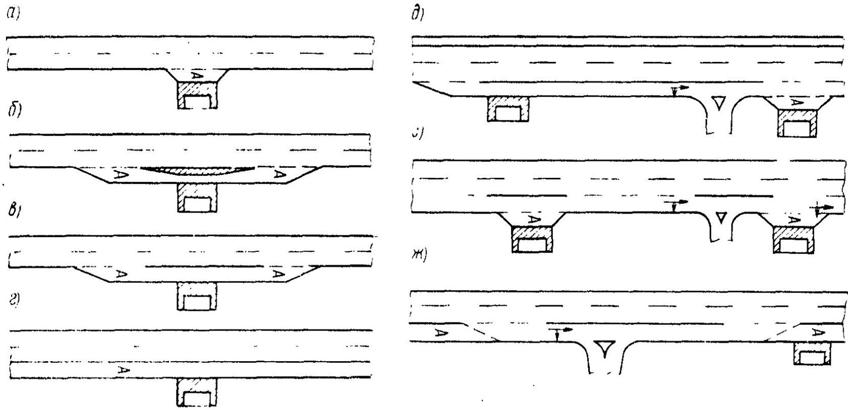
Рис. 18.1 Варианты планировочных схем устройства автобусных остановок:
