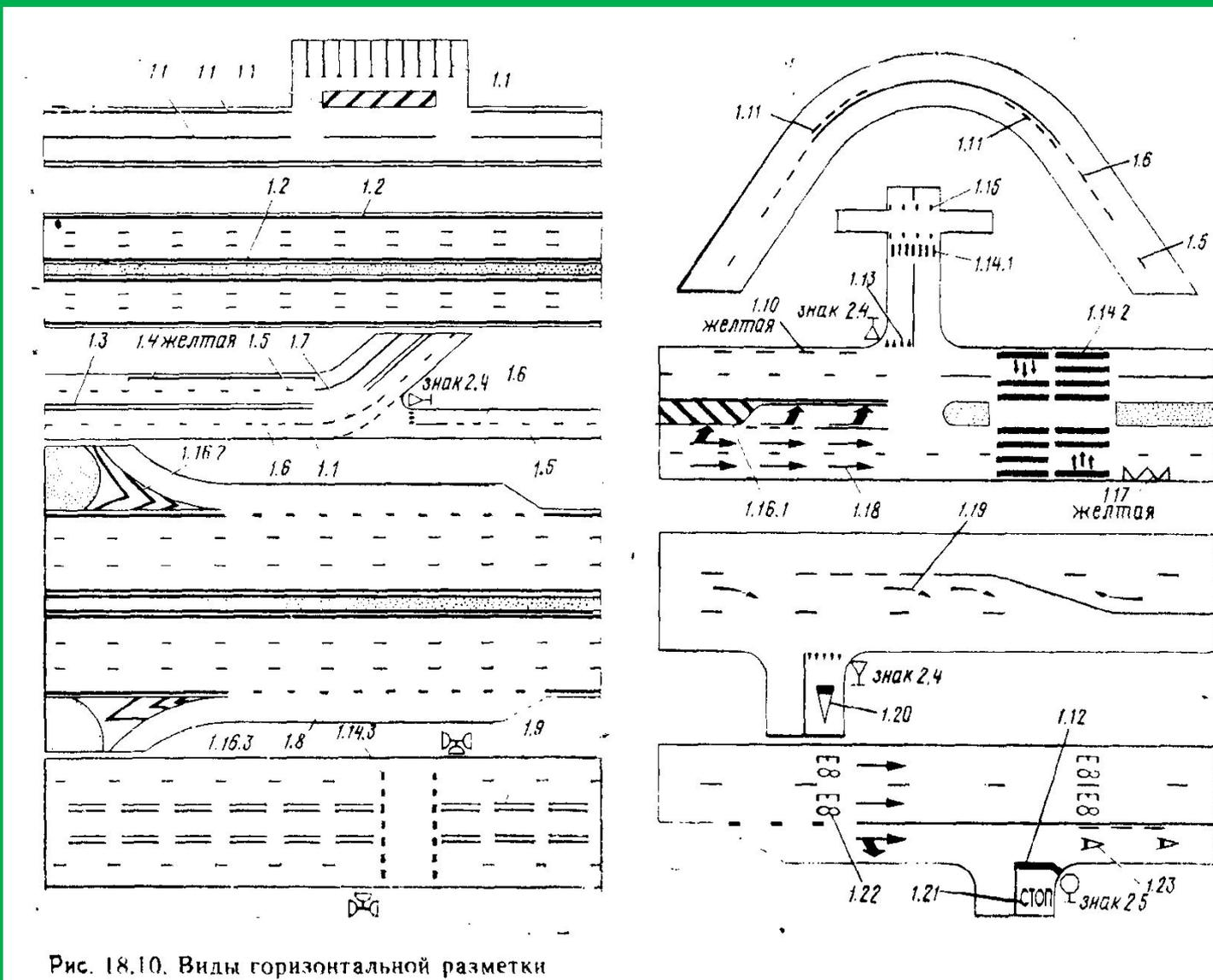
Рис. 18.10. Виды горизонтальной разметки
