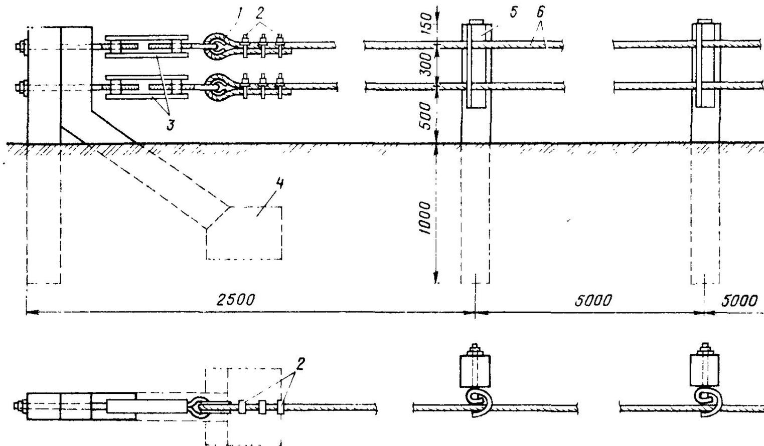
Рис. 18.18. Ограждение из стальных тросов, закрепленных через амортизаторы на железобетонных стойках:
