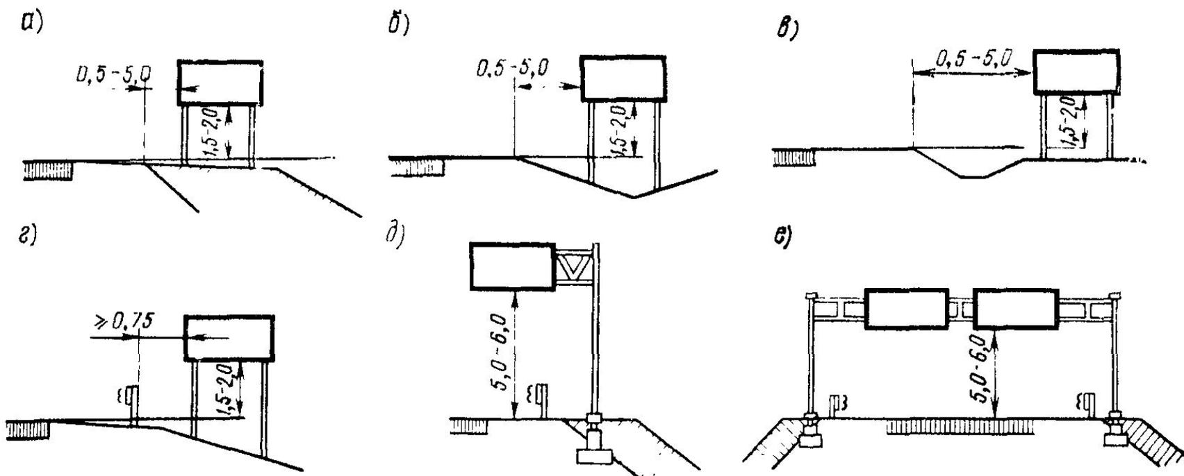
Рис. 18.8. Способы установки предварительных указателей направлений
