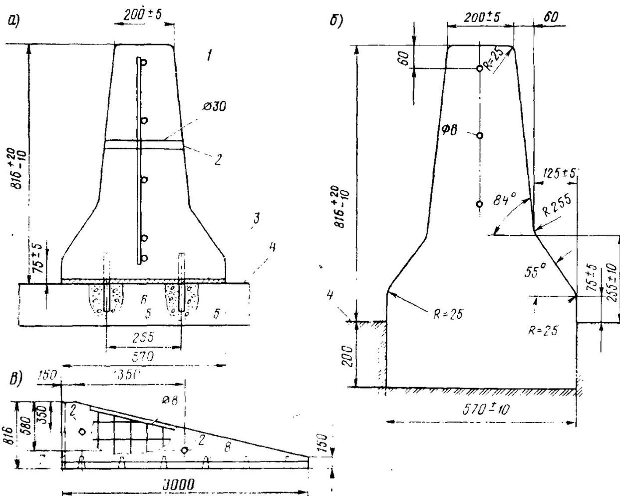
Рис. 18.20. Железобетонные ограждения паралетного типа.
