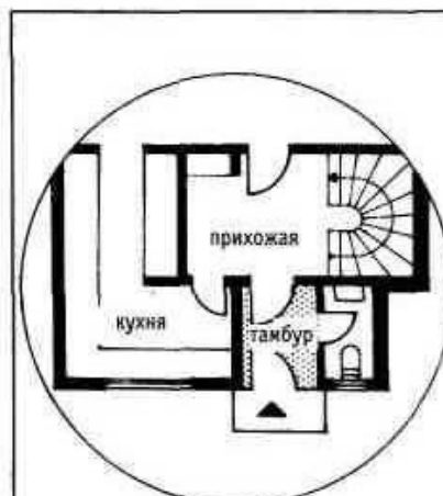
12 Тамбур и прихожая с лестницей в подвал и на второй этаж
