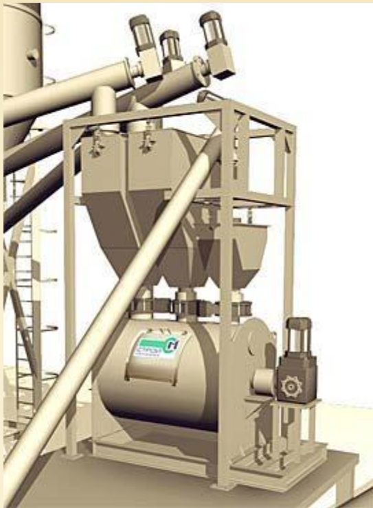
Узел дозации и смешивания компонентов
