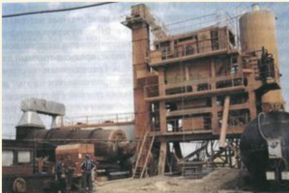
Рис. Асфальтосмесительная установка с дозатором свободных целлюлозных волокон
