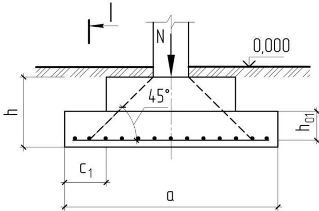
Далее выполняют расчеты прочности фундамента на раскалывание, а также наклонных и нормальных сечений подошвы, работающей на изгиб.
