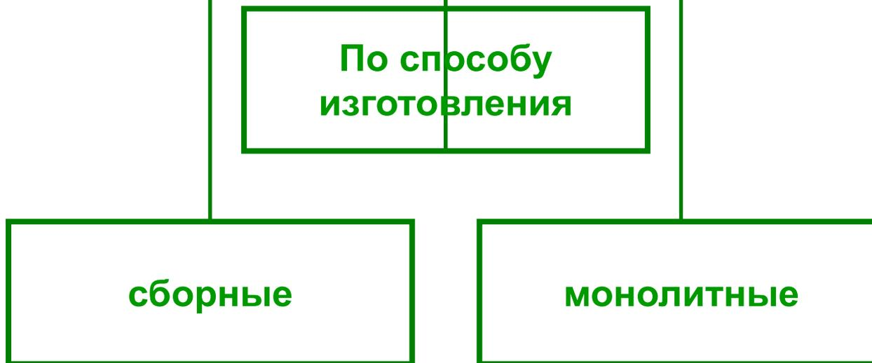
Технико-экономическое сравнение показывает, что стоимость монолитных фундаментов, как правило, ниже стоимости сборных. Применение сборных отдельно стоящих фундаментов целесообразно для достижения полносборности зданий при большой повторяемости сборных конструкций, а также при строительстве удаленных объектов. Применение сборных фундаментов позволяет сократить сроки строительства, облегчает ведение работ в зимнее время и в сложных гидрогеологических условиях.
