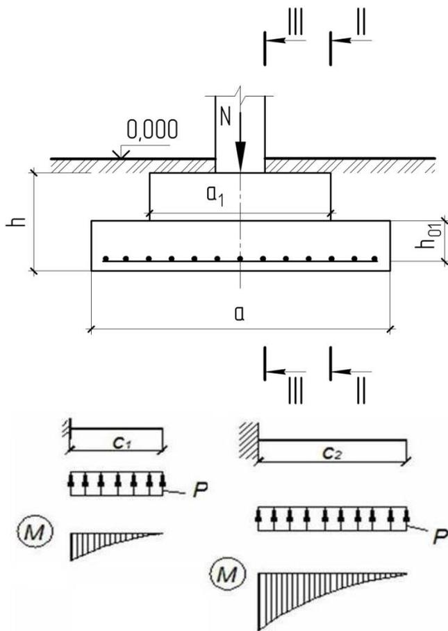
Армирование фундамента по подошве определяют расчетом на изгиб по нормальным сечениям (II - II и III - III).
