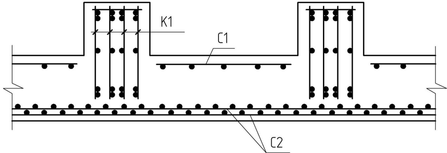
Ребристые плиты рекомендуется применять при нагрузках более 10 000 кН на колонны и расстояниях более 9 м между ними. Такие плиты могут оказаться целесообразными также при необходимости обеспечения большой жесткости фундамента.
