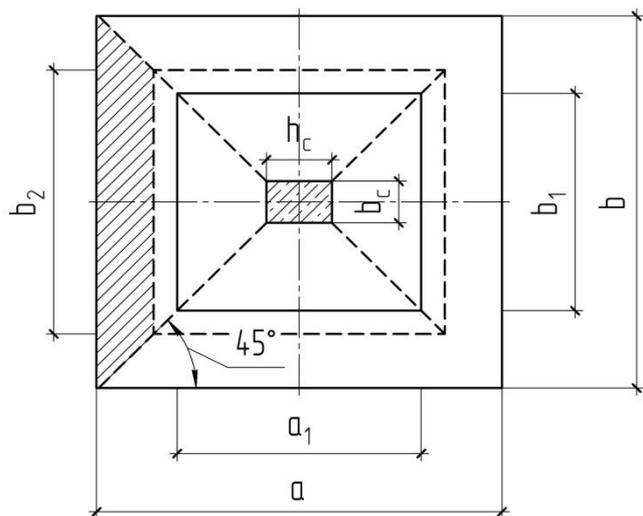
Сила, воспринимаемая поперечным сечением бетона фундамента  $F_b = R_{bt} \cdot h_0 \cdot U_m$ , где  $R_{bt}$  - расчетное сопротивление бетона при растяжении;
