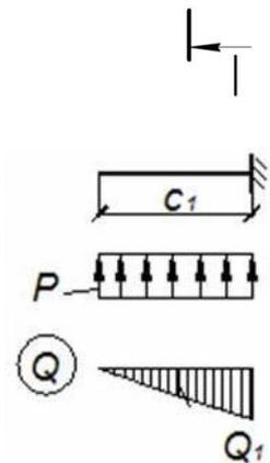
Полезную высоту нижней ступени  $h_{01}$  назначают такой, что бы она отвечала условию прочности по поперечной силе без поперечного армирования в наклонном сечении начинающемся на границе пирамиды продавливания (сечение I-I):  $Q_1 \leq Q_{b,min}$
