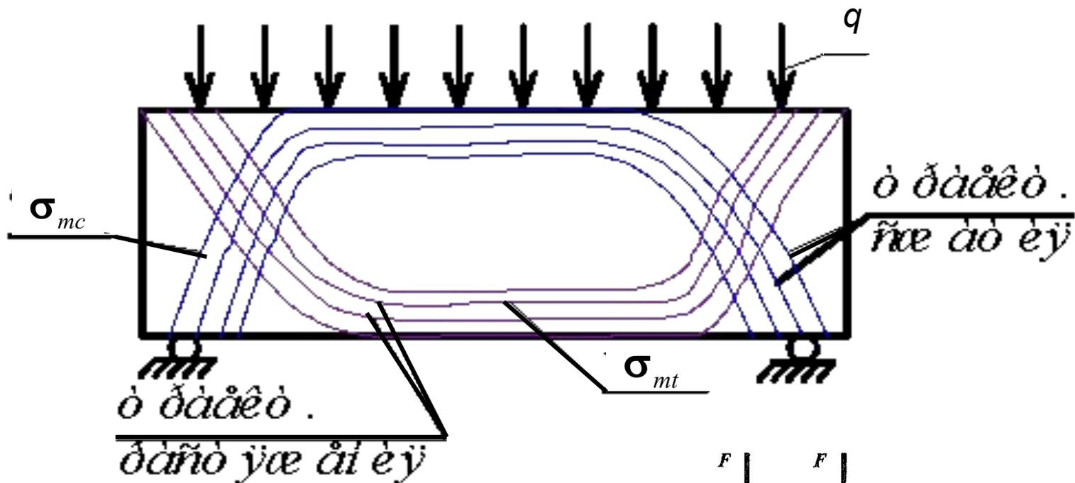
Траектории напряжений сжатия и растяжения в балке
