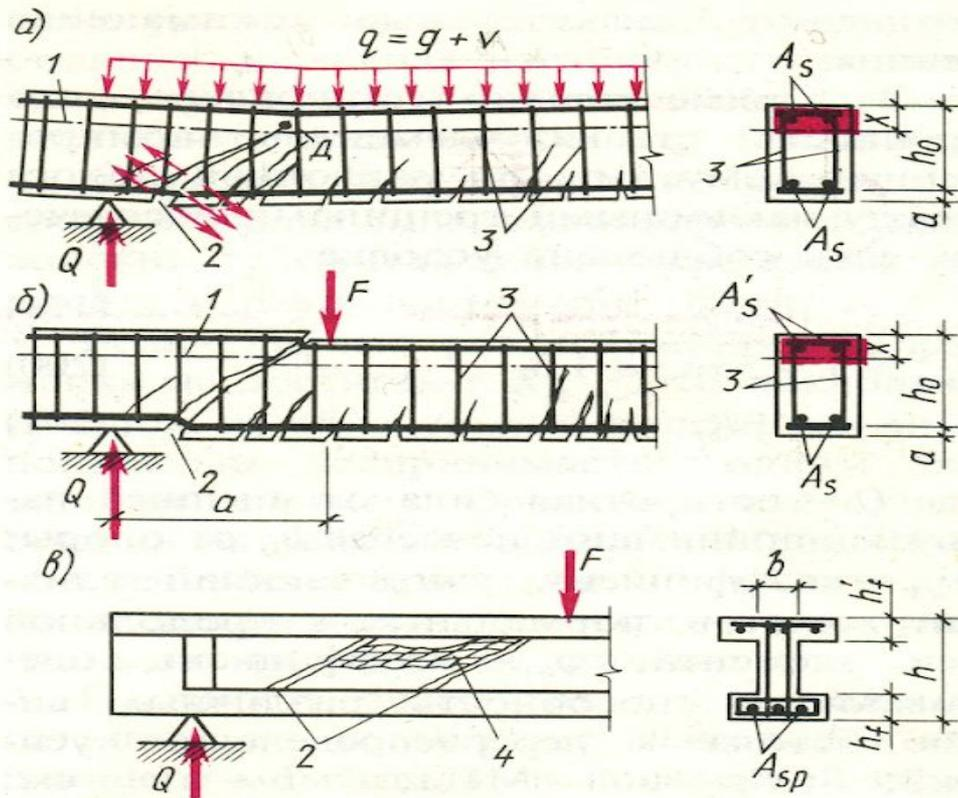
Схема разрушения изгибаемых элементов по наклонному сечению:
