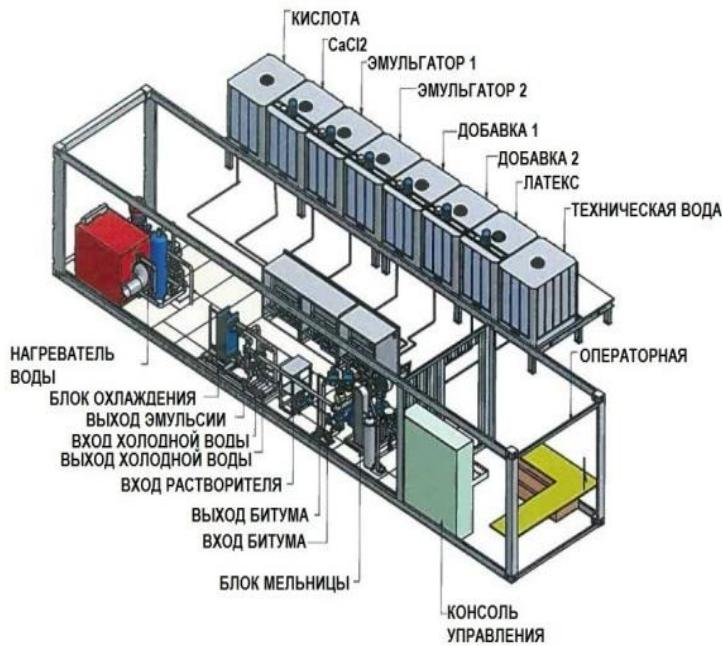
Установка занимает относительно мало места и смонтирована в мобильном исполнении в стандартном 40 футовом контейнере. Все оборудование очень удобно в эксплуатации и позволяет использовать все необходимые химикаты, применяемые при производстве битумных эмульсий.
