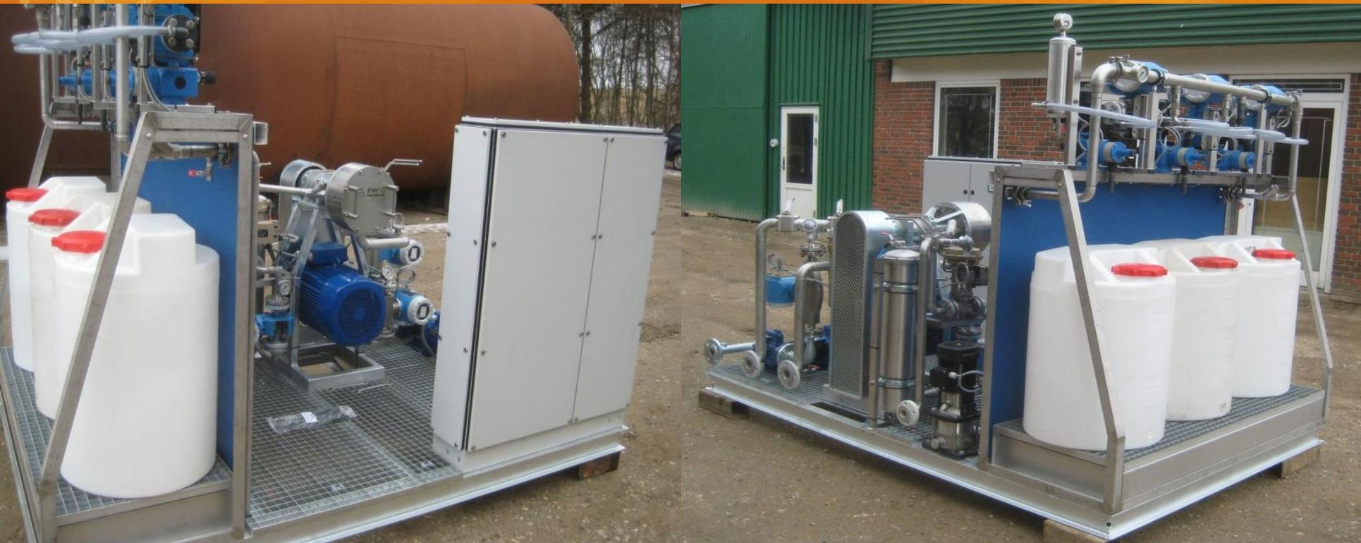
Данные установки выполнены на единой SKID-платформе, предназначены для производства кислотной и щелочной эмульсий. При строительстве дорог с многослойным покрытием применение эмульсий обеспечивает надежное сцепление укладываемых слоев, повышая характеристики покрытия по сдвигу. Установка позволяет производить эмульсию с процентным содержанием битума от 50 до 69%.
