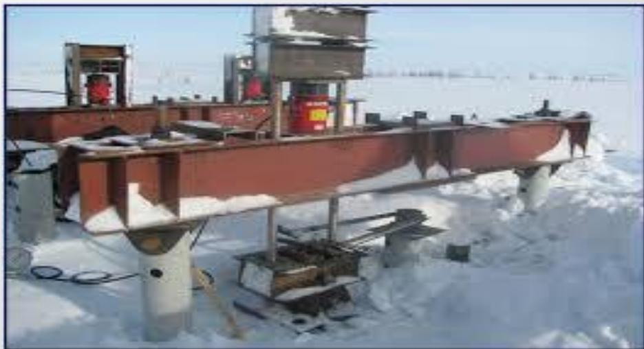
Цель испытания свай статической вдавливающей и выдергивающей нагрузкой :
