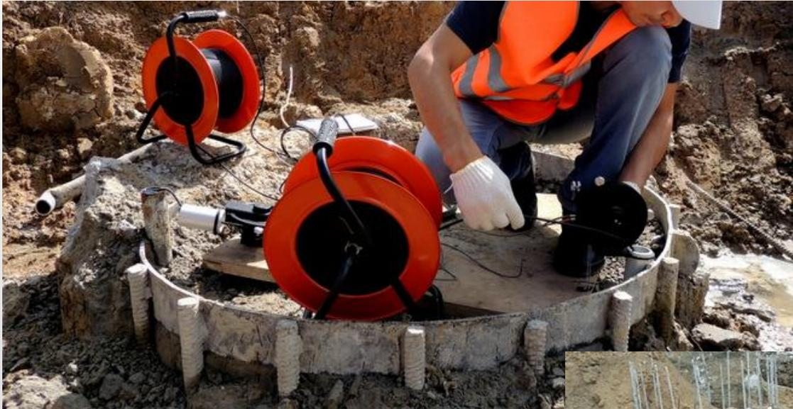
Метод основан на изменении скорости ультразвуковых волн в средах в зависимости от их структуры и физико-механических свойств.
