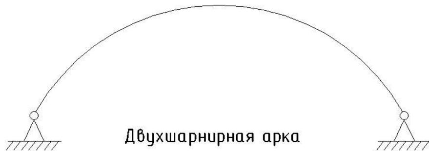
По схеме опирания их делят на арки с затяжками, воспринимающими распор и на арки без затяжек, распор которых передается на опоры.
