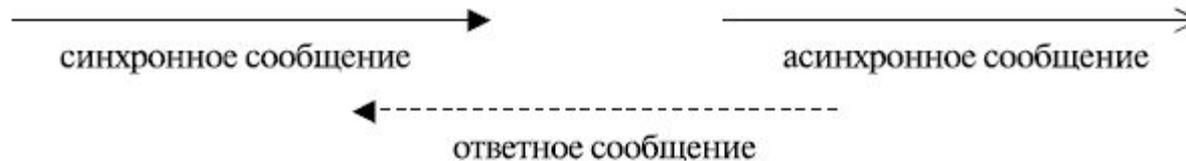
Первая разновидность сообщения наиболее распространена и используется для вызова процедур, выполнения операций или обозначения отдельных вложенных потоков управления. При этом принимающий объект может получить фокус управления, становясь в этом случае активным. Передающий объект может потерять фокус управления или остаться активным.
