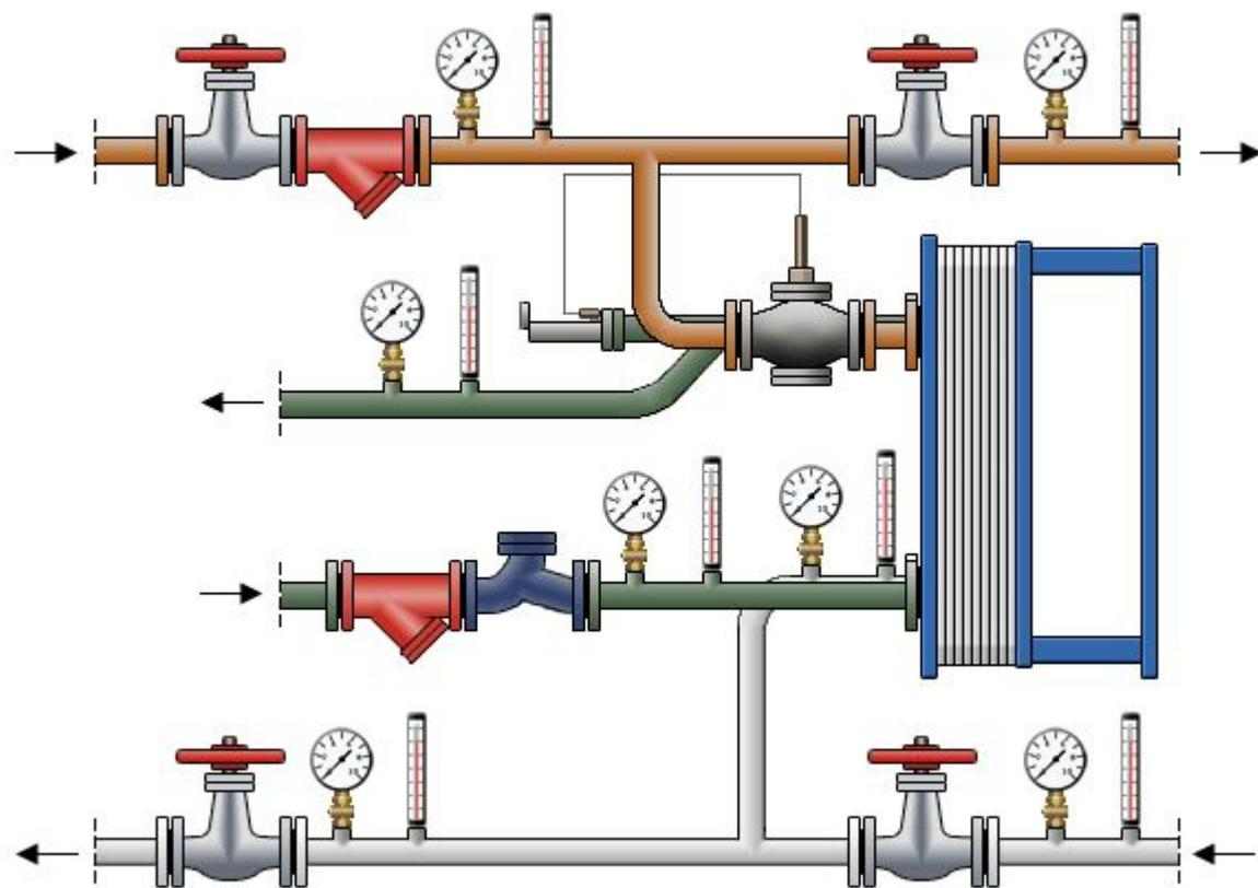
Пример установки регулятора температуры на теплообменнике ГВС
