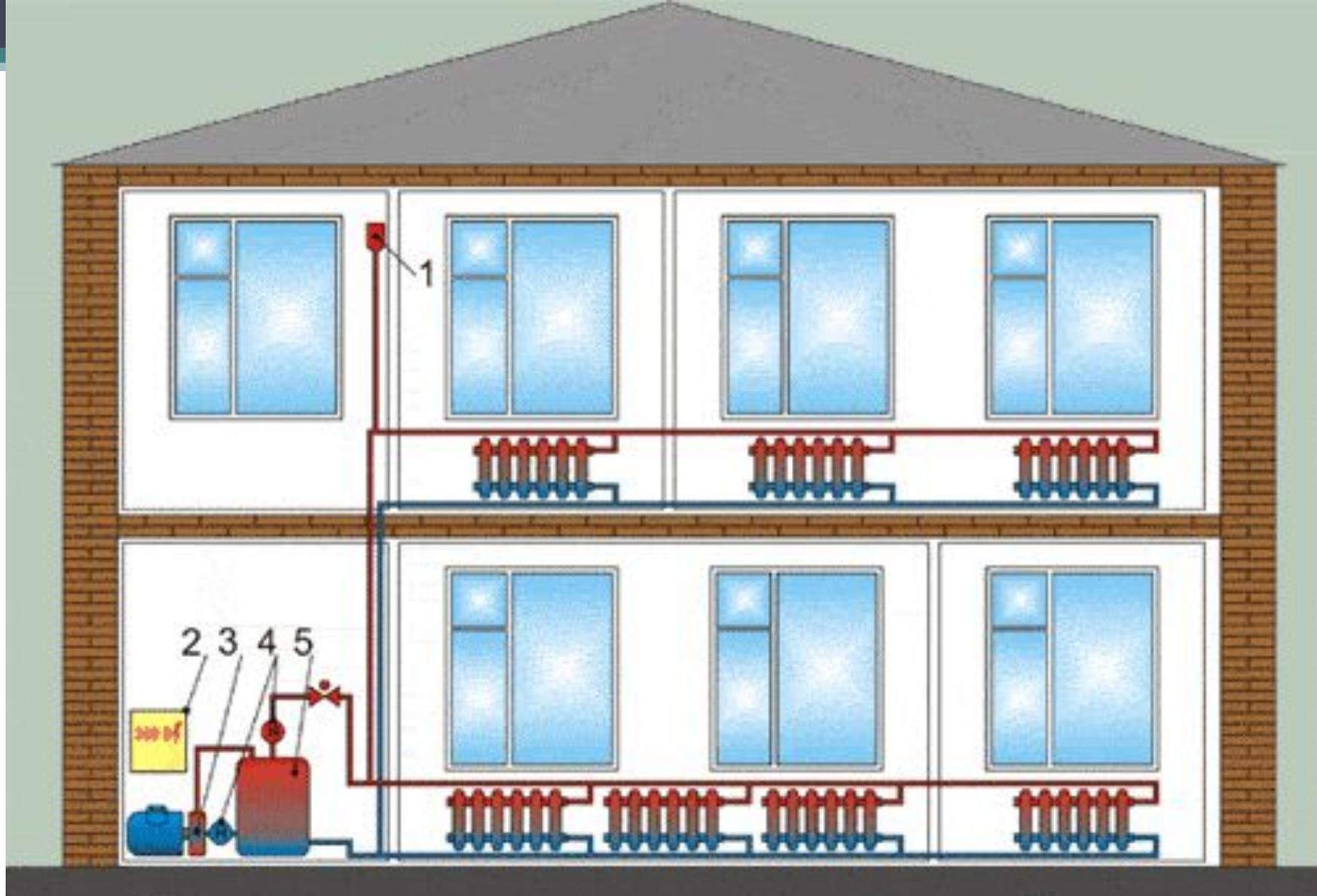
Типовая схема подключения вихревого теплогенератора к системе водяного отопления:
