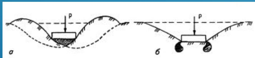
Рис. 3. Схемы расчетных моделей, схематизирующих зависимость между осадкой и нагрузкой на грунт: а — основание, работающее в условиях предельного равновесия; б — упругого слоя, работающего в условиях смешанной задачи теории упругости и теории пластичности
