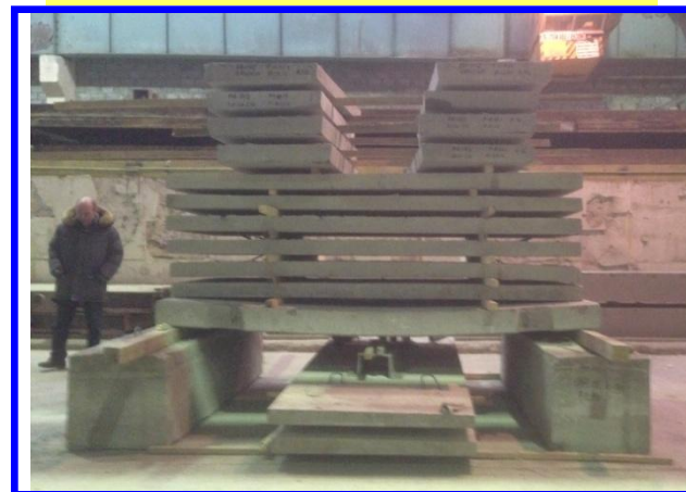
Контрольная нагрузка 8т – плита не разрушена
