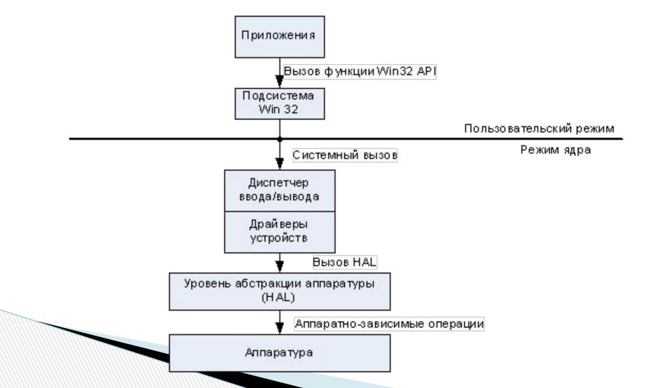
Схема обработки системного сервиса:
