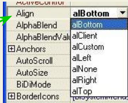
**Align** – свойство, определяющее положение формы на экране. Например, если мы выберем это свойство равное значению **alClient**, то форма займет весь экран
