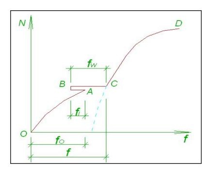
• AO — прогибы стержня до усиления  $(f_0)$ , AB — обратный выгиб от присоединения усиливающего элемента  $(f_I)$ ; BC — прогиб при сварке  $(f_W)$ ;  $C\mathcal{I}$  — рост прогиба после усиления при возрастании нагрузки.
