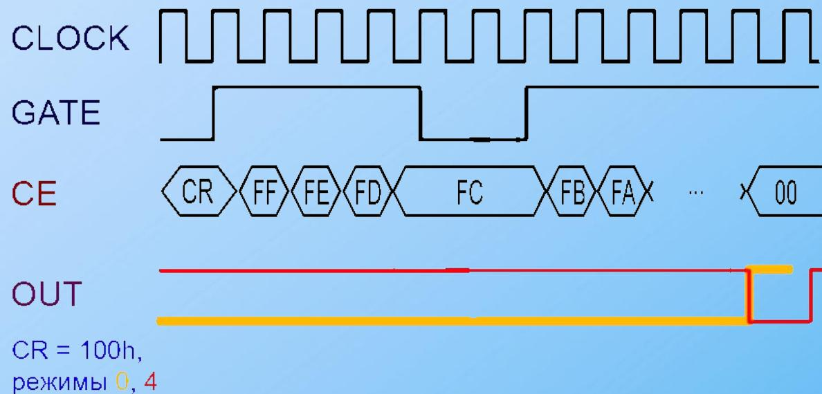
При работе с перезапуском не требуется повторного программирования таймера для выполнения той же функции. По фронту сигнала GATE значение константы из регистра CR вновь переписывается в регистр CE, даже если текущая операция не была завершена.
