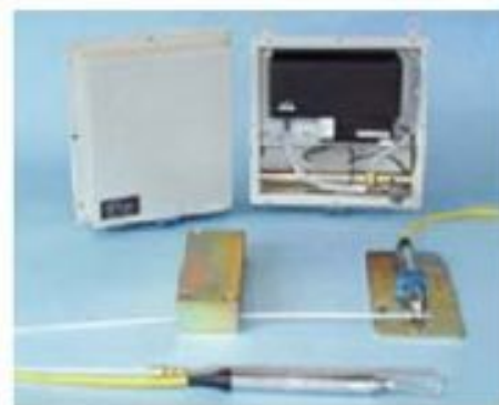
DSM система контроля осадки здания
