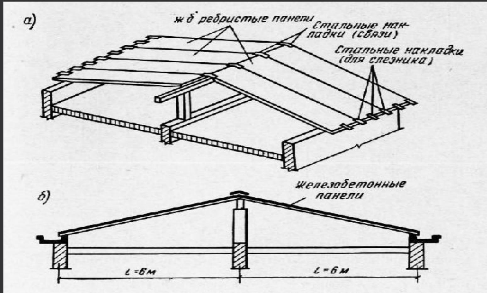
Железобетонные крыши из полносборных элементов-наиболее индустриальный и распространённый тип, применяемый в городском строительстве.
