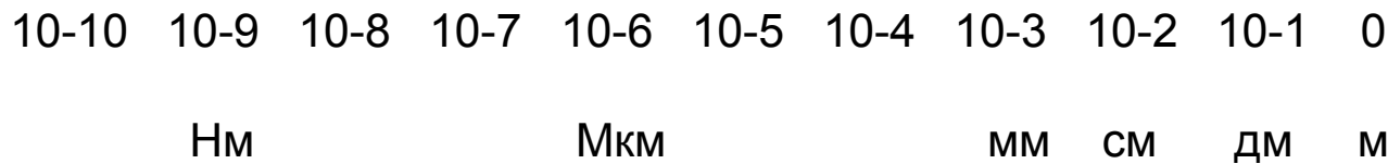
Рис. 1. Цифровая линейка, определяющая пределы изучения структуры строительных материалов в зависимости от размеров структурных элементов
