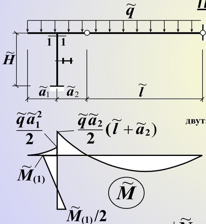
Определить статистические характеристики нагрузки  $\tilde{q}$ , вызывающей в сечении 1–1 фибровое напряжение  $\tilde{\sigma}_0$ , не превышающее детерминированное значение  $R$  с необходимой вероятностью  $P_{\sigma_0}$ . Вероятностные свойства геометрических параметров конструкции известны:
