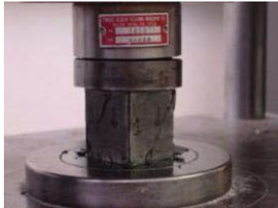
Пресс для определения предела прочности цементного камня
