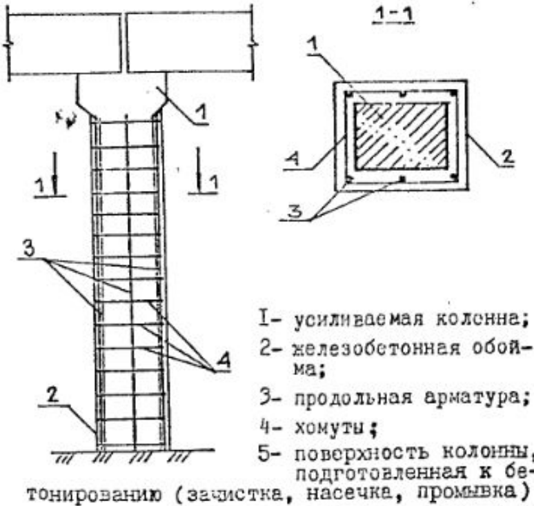
УСТРОЙСТВО ЖЕЛЕЗОБЕТОННОЙ ОБОЙМЫ
