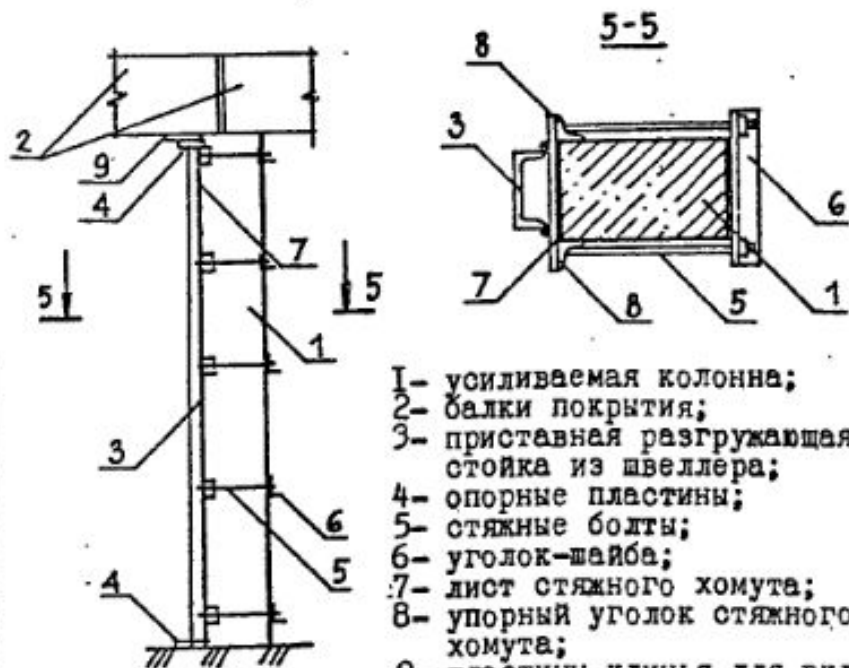
УСТАНОВКА ПРИСТАВНЫХ РАЗГРУЖАЮЩИХ СТОЕК
