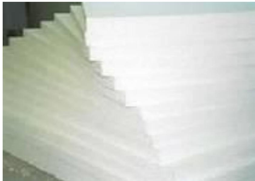
Вспененные полиэтилен и полипропилен
