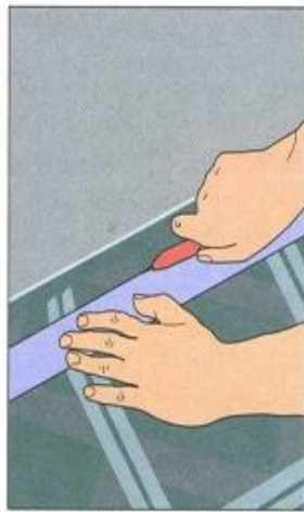
Окончательно (по линейке) прирезать полотнище
