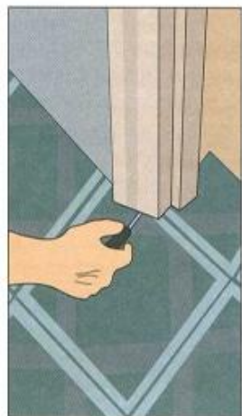
В дверных проемах подсунуть линолеум под наличник и косяк
