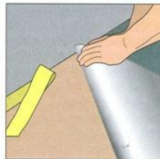
Отогнуть линолеум и наклеить скотч
