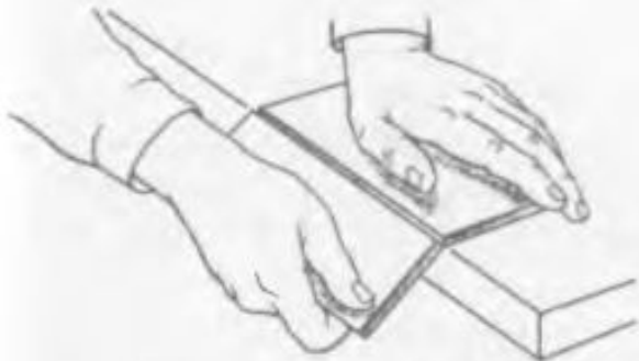
Рис. 2. Раскол плитки Рис. 3. Выравнивание кромок неполномерных плиток прямыми кусачками
