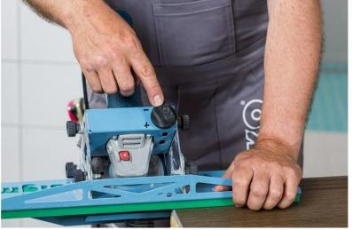
Мобильные саморезки для точного резания каменотесным угольником (jolly hrany) настраиваются в диапазоне от 35° до 55° - копируют допустимые отклонения плоскостности плитки и обеспечивают равномерное резание
