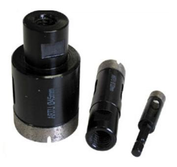
Для сверления в спекшихся покрытиях используем коронки, которые справятся не только с мягкой облицовкой, но изначально они предназначались для спекшихся керамических черепков с твердостью 7 (маркировка коронок "gres porcelanato" или "porcelain"). Поступаем согласно инструкции, соблюдаем обороты, не надавливаем, а в случае требования произв<mark>одителя</mark> охлаждаем водой:
