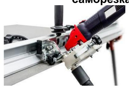
Полозная саморезка с присосками длиной 150 см с возможностью налаживания до 420 см и приспособлением для каменотесного угольника (jolly hranu) со встроенным шлифовальным приспособлением.
