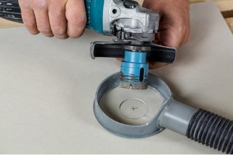
✓ Вытачивание круглых пазов сухим методом начинаем под углом 45°, для того, чтобы образовалась нужная канавка.
