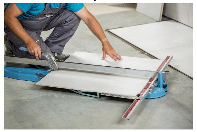
**Крепкие гильотинные саморезки для больших** форматов, из алюминиевого сплава – саморезка и алмазные колесики оснащены шарикоподшипниками.
