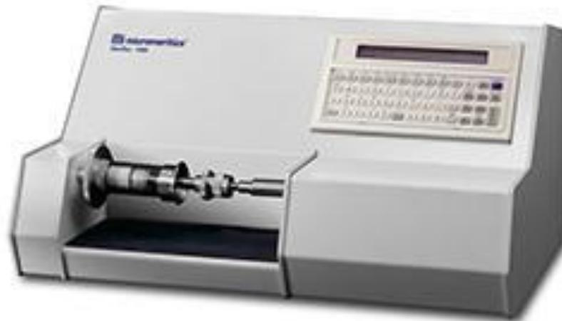
Объем образца, включающий поры и пустоты, определяется путем помещения его в квазижидкую среду, состоящую из маленьких полимерных сфер. Прибор фиксирует данные, делает необходимые вычисления и выводит данные на принтер или экран. Если ввести значение истинной плотности этого же образца то прибор выдает данные по общей пористости и удельному объему пор.
